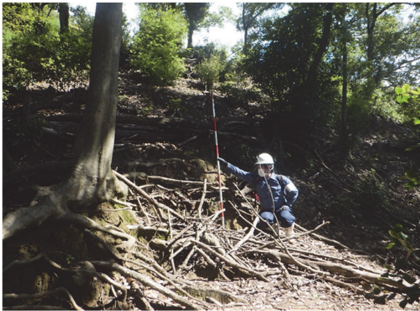
写真1 斜面上部の滑落崖の状況。 高さ2 m程度で、崖地形はやや浸食を受けており、古い滑落崖と考えられる。
