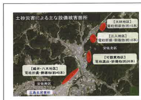
図-10 電力設備の被害地域
