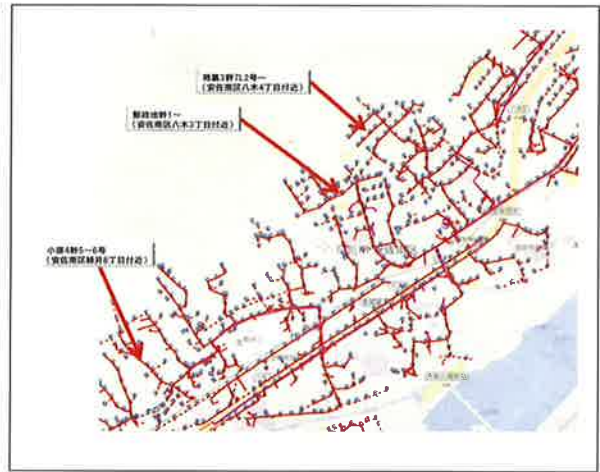
図-17 電柱倒壊位置（丸印）
